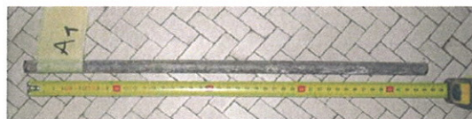
Prelievo di barra d'armatura.
