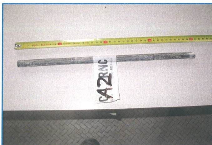
Prelievo di barra d'armatura.
