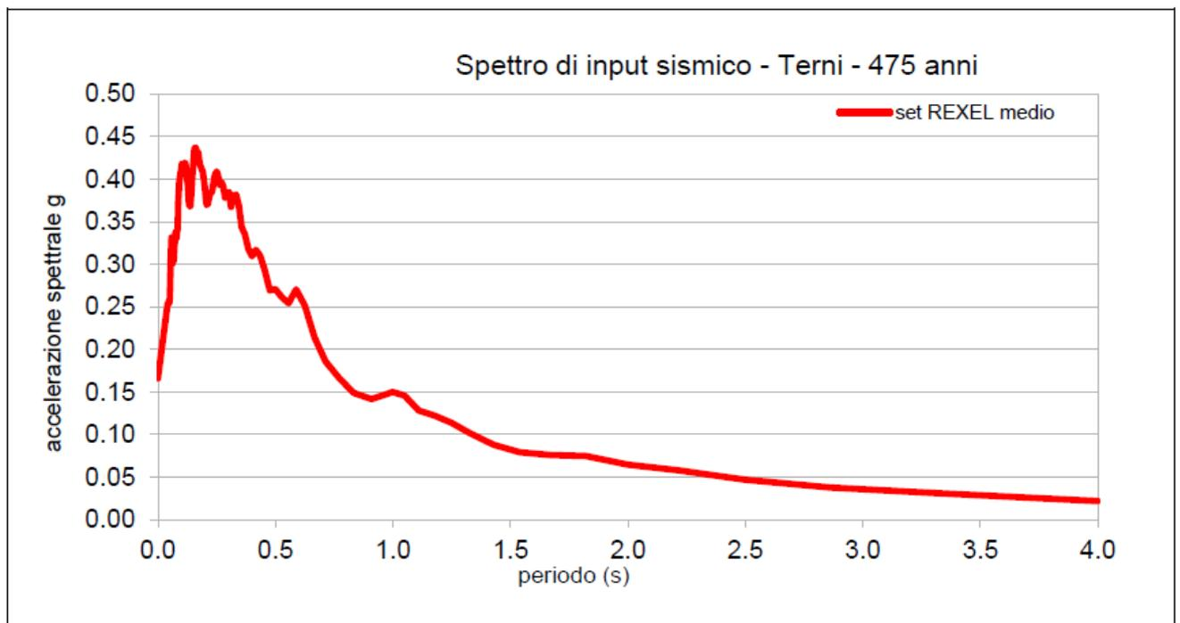
Qui sotto è riportato il confronto tra lo spettro di input sismico per Terni (ottenuto come valore medio di un set composto da 7 accelerogrammi, ognuno derivante da ogni terremoto estratto da Rexel e che il software ritiene significativo per la località prescelta) e lo spettro di sito per un suolo rigido di categoria A (Bedrock). Sono inoltre riportati anche gli spettri per le altre categorie di suolo.
