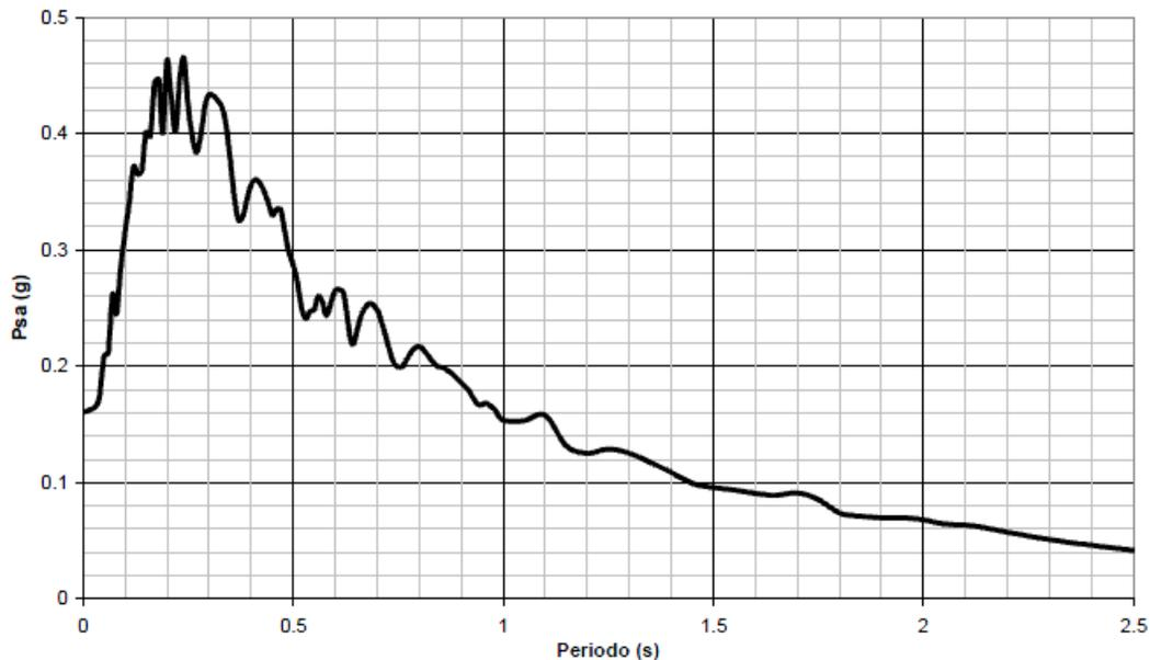
Spettro utilizzato per il sito di Terni dal Politecnico di Milano in occasione degli studi di MSS del posto sisma di Narni (16.12.2000 e per il completamento degli studi di microzonazione sismica del PRG di Terni (2002-2004) tempo di ritorno di 475 anni.
